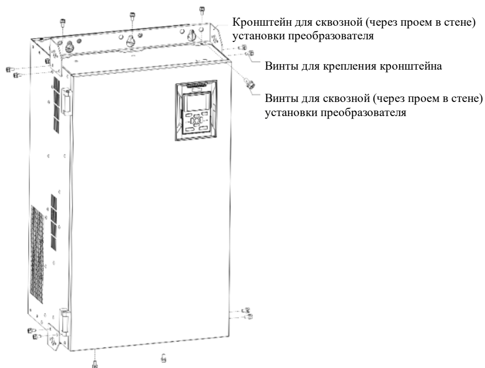
Рис. 2-9 Схема сквозной (через проем в стене) установки преобразователя (380 В) модели 132G/160P–160G/185P преобразователя (660 В) модели 160G/185P–200G/220P-6
