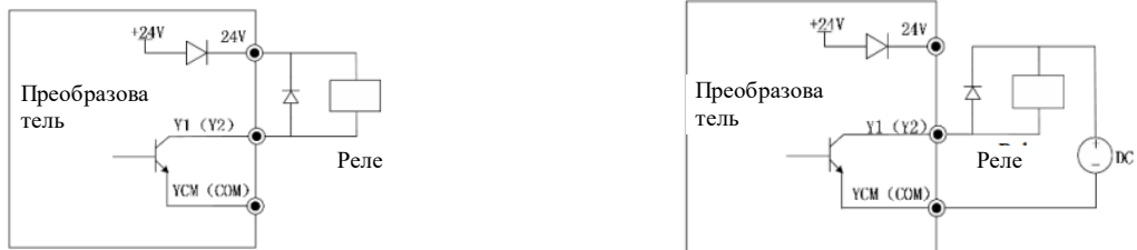
Рис. 3-14 Подключение многофункциональных выходных клемм
