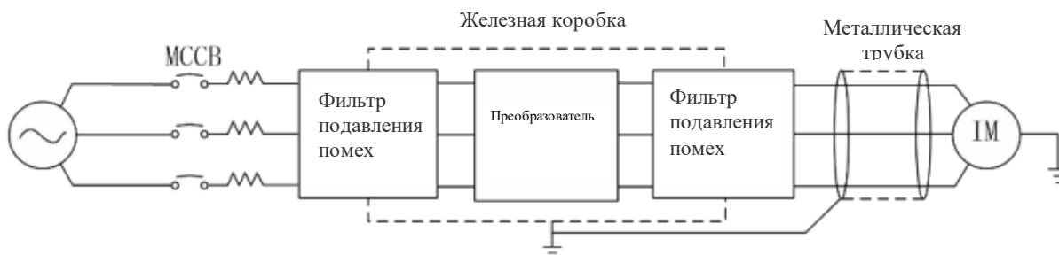
Рис. 3-10 Устранение проблемы радиочастотных помех
