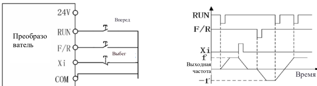
(a) Схема электрических соединений трехпроводного управления (F00.03=2)
