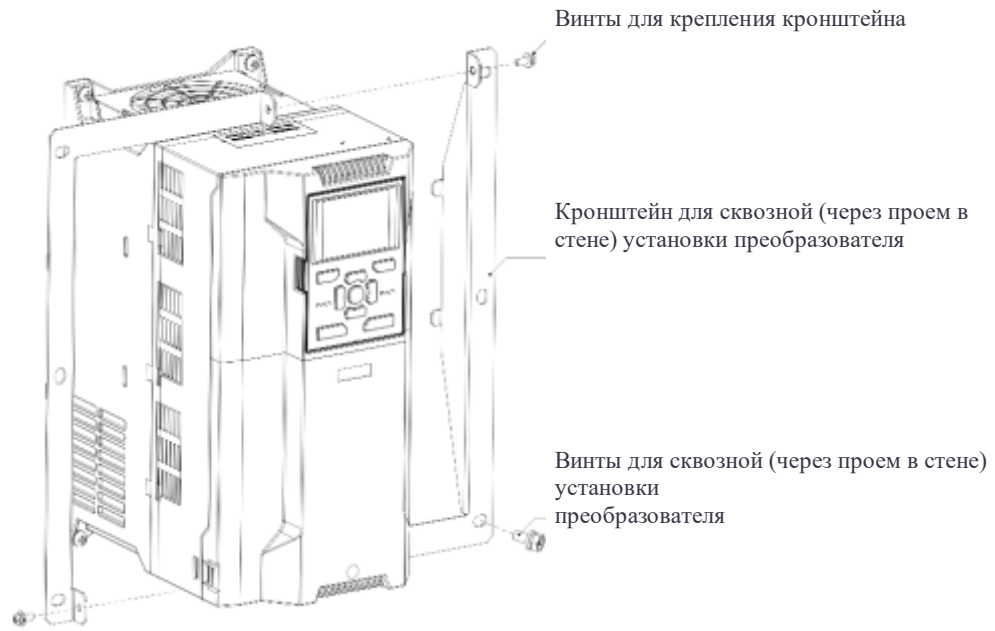
Рис. 2-7 Схема сквозной (через проем в стене) установки преобразователя (380 В) модели 0R7G/1R5P-022G/030P
