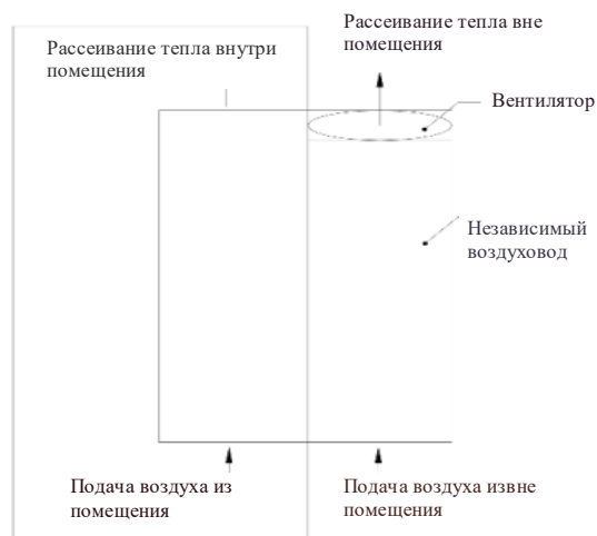
Рис. 2-6 Сквозная (через проем в стене) установка преобразователя
